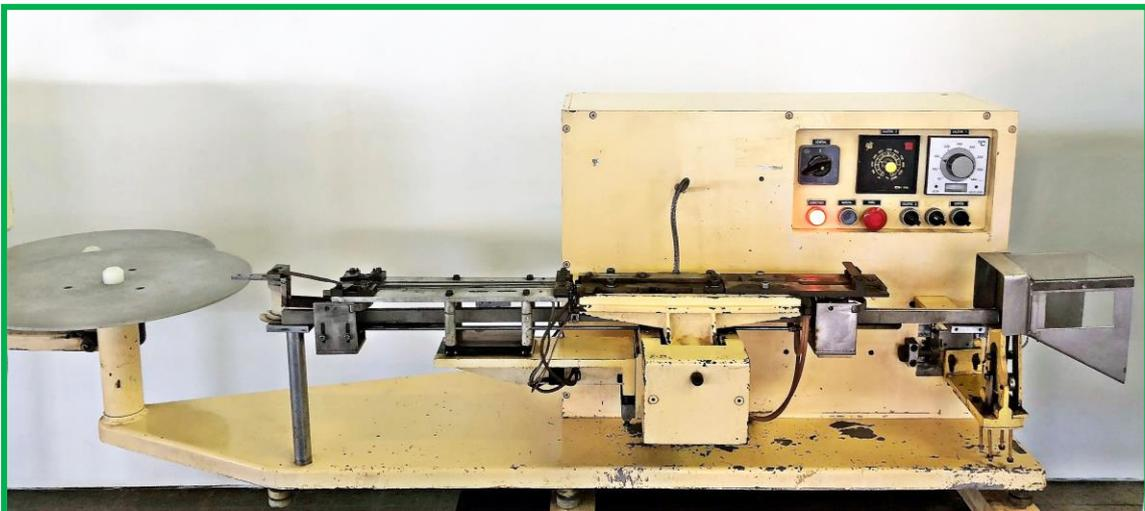
Máquina para la soldadura de la boca del alveolo preformado después del dosificado.
