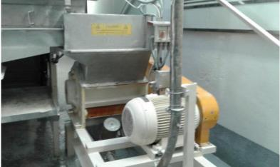
Foto en la instalación original donde funcionaba La extracción del producto en la instalación de donde fue retirado, se hacía por transporte neumático mediante una bomba soplante de 5,5 KW (bomba no incluida)
