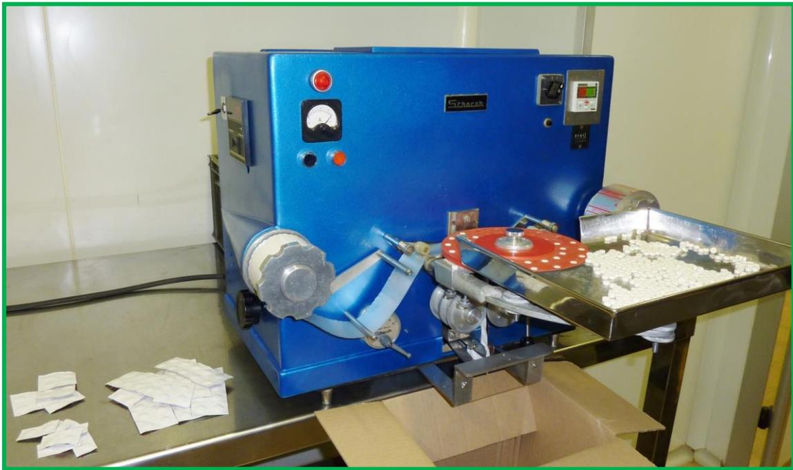
Dispone de un formato con disco doble de 2 x 18 divisiones para envasar comprimidos de  $\text{Ø}$  8 mm x 4 mm de altura con el que se ha probado la máquina:
