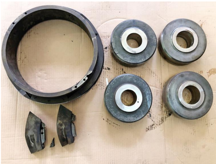
Guías construidas nuevas antes de llevar al temple:
